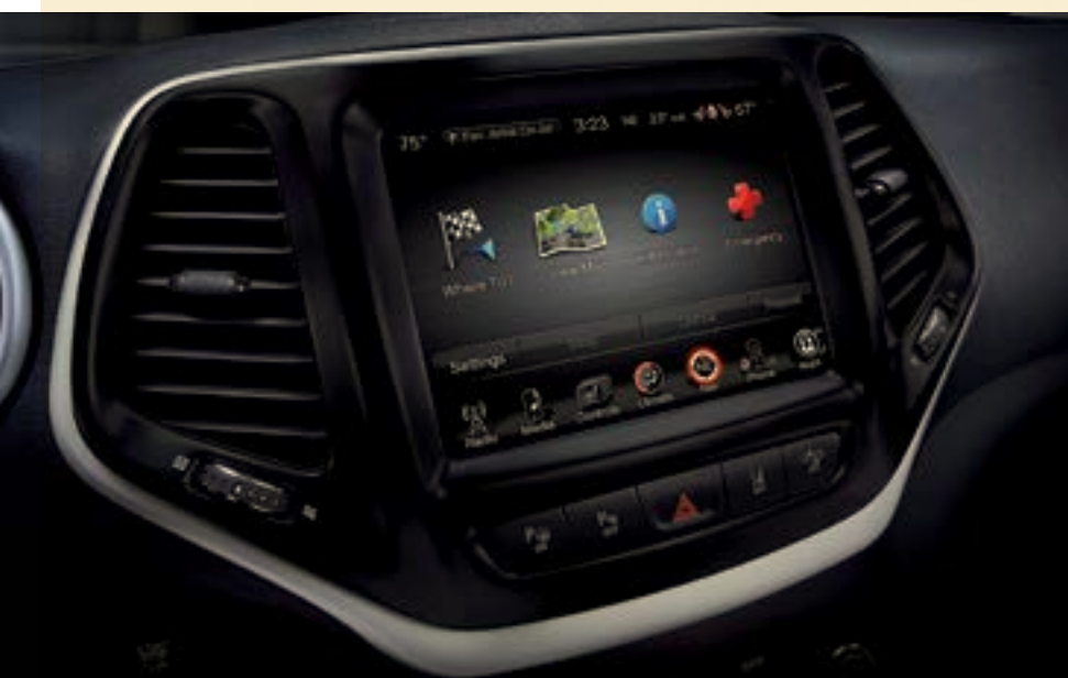
Fernbedienung via Smartphone und drahtloses Internet im Auto als Einfallstor für Hacker. Sobald man Motordaten von Ferne auslesen kann, ist die Datensleuse offen und muss durch aufwendige Sicherheitssoftware wieder verriegelt werden. Das ist oft nicht der Fall. Links: Multimedia im Jeep Cherokee, gemeinsam mit Aufsperrn, Zusperrn und Motorstarten auf einem Elektronikmodul. So geht's gar nicht, sagt die ICT-Community einhellig.
